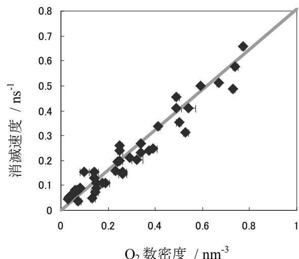
図 1. 消滅速度の O<sub>2</sub> 数密度依存性
