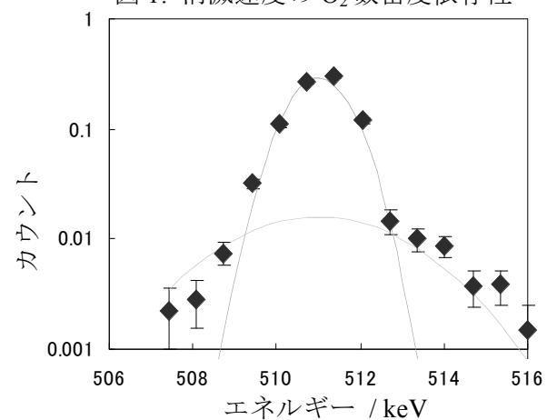
図 2. o-Ps の消滅 γ 線スペクトル
