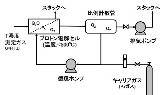
図2 トリチウムモニターの構成
