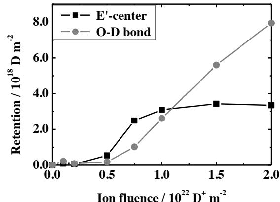
図 イオンフルエンスの変化に伴う各捕捉サイトの重水素滞留量の変化
