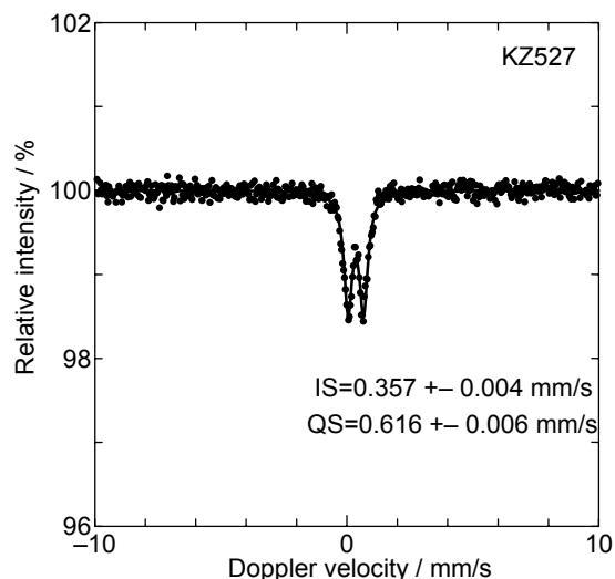
図 1. NaCl 水溶液/鉄板の腐食生成物（滴下後 20 時間）のメスバウアースペクトル
