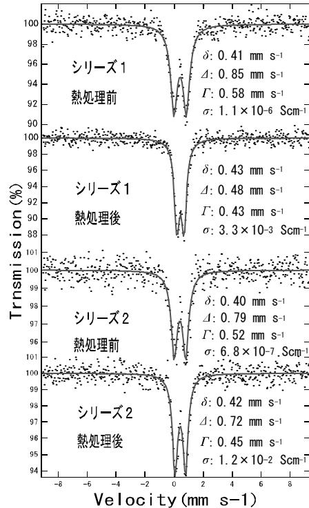
Fig. 1. 热処理前および熱処理後の正極材料のメスバウアースペクトル
