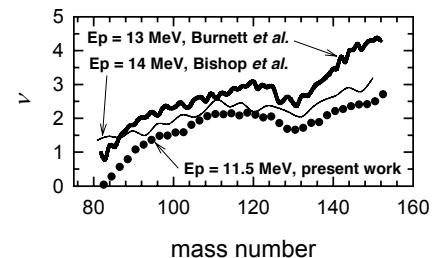
図1 中性子数  $\nu$  の質量依存性
