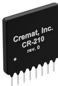
CR-210はベースライン・レストアラ(回復回路)で、ベースラインのシフトを補正します。AC結合のパルス増幅器では、ベースラインのシフトによって波高スペクトルの分解能が低下する可能性があります。
