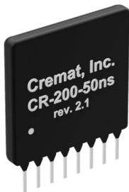
CR-200シリーズはガウシアン・シェーピングアンプで、チャージ・センシティブ(電荷有感型)プリアンプから入力されるテールパルス信号を読み取ります。ステップ状の入力パルスを、ガウス関数のような形状にシェーピング(整形)して出力します。
